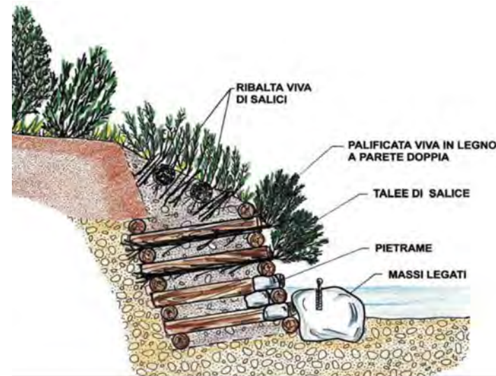
Esempio 1. Schema consolidamento spondale con palificata viva
