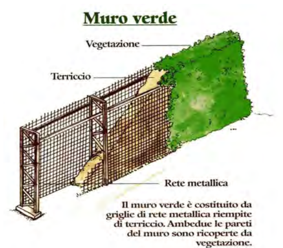
Esempio 2. Schemi tipologici di dune fonoassorbenti e muro verde con terra armata, tratti da "Il Divulgatore - Agricoltura, Alimentazione, Ambiente – Fasce di ambientazione e corridoi ecologici per mitigare l'impatto delle strade e favorire la biodiversità" (Mensile della Provincia di Bologna – Giugno 2005)
